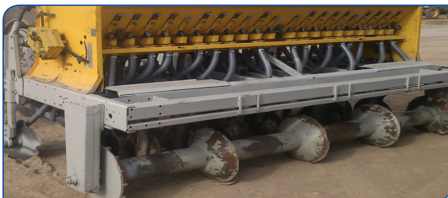
شکل ۱۰- دستگاه مخصوص کشت بر روی پشته های بلند دائم
