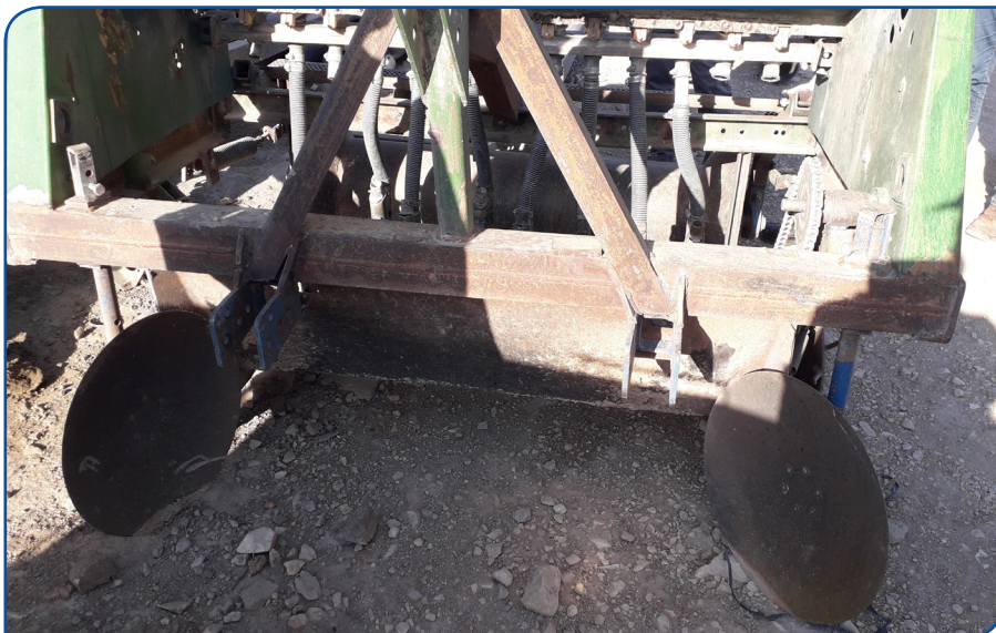
شکل ۱۱- دستگاه مخصوص کشت روی بسترهای بلند دائم نوع دیسکی
