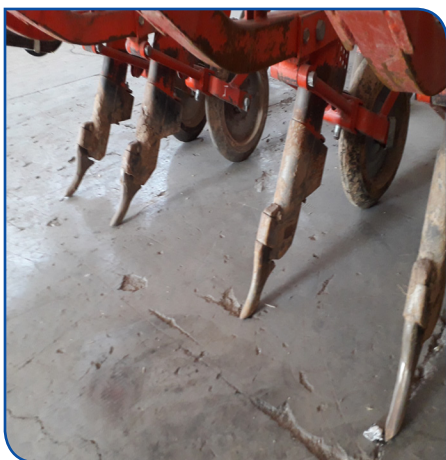
شکل ۸- شیار بازکن مخصوص کشت مستقیم. خاک زیر بستر بذرتا عمق ۵ تا ۱۰ سانتی متر نرم می شود
