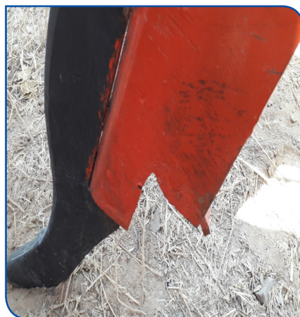
شکل ۸- شیار بازکن مخصوص کشت مستقیم. خاک زیر بستر بذرتا عمق ۵ تا ۱۰ سانتی متر نرم می شود
