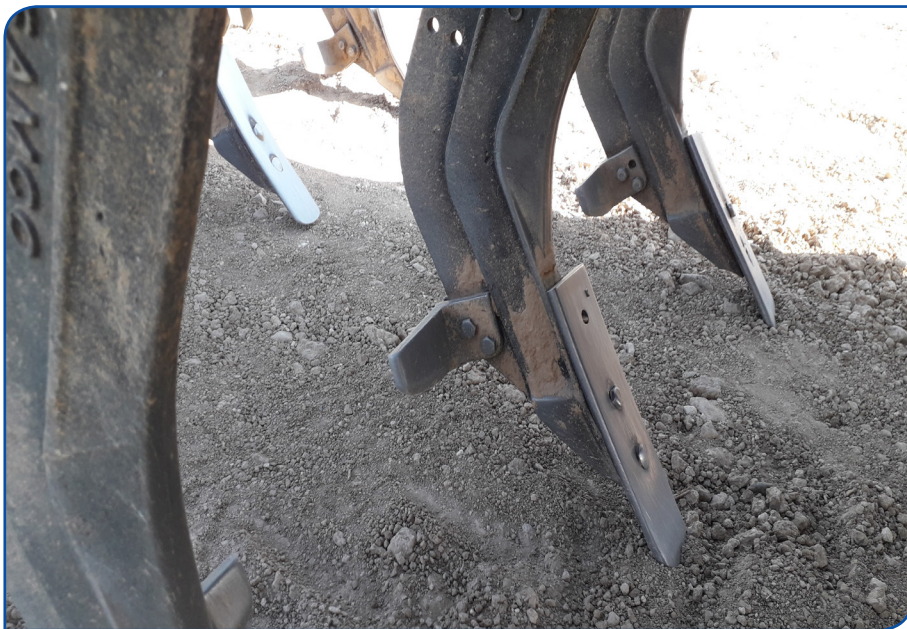
شکل ۴- باله های ال شکل و موقعیت آن نسبت به نوک تیغه در گاواهن پیزا - پکر
